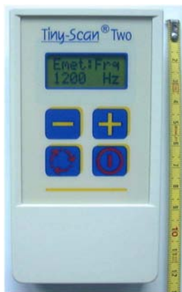
Fig. 9: Le générateur de champs magnétiques pulsés TINY-Scan® II.
